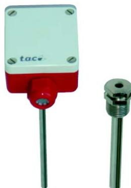
STP100 / STP101 è studiato per il montaggio sulla tubazione, separatamente si può avere anche il pozzetto in acciaio inossidabile o in ottone PN16. così, in caso di necessità, sostituzione del sensore è facile e rapida. STP100 è il modello completo di pressacavo Pg11, mentre STP101 presenta un foro di ingresso cavo con Ø 20 millimetri.
